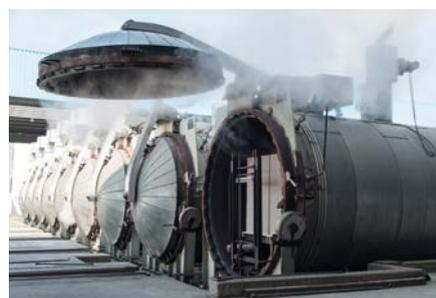
Die Rohlinge werden in Autoklaven gehärtet
