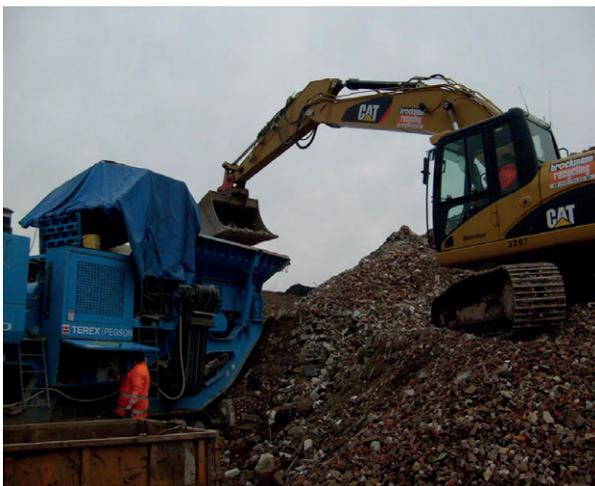
Beschickung der Brecheranlage
