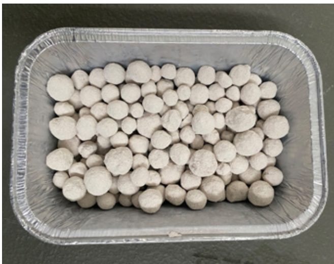
Hydrothermalgranulate aus Kalksandstein-Recycling-Material – Durchmesser der Granalien: 5 bis 20 mm
