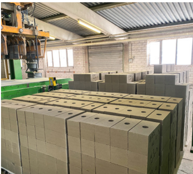
Herstellung von Kalksandsteinmustern mit Betonbrechsand.
