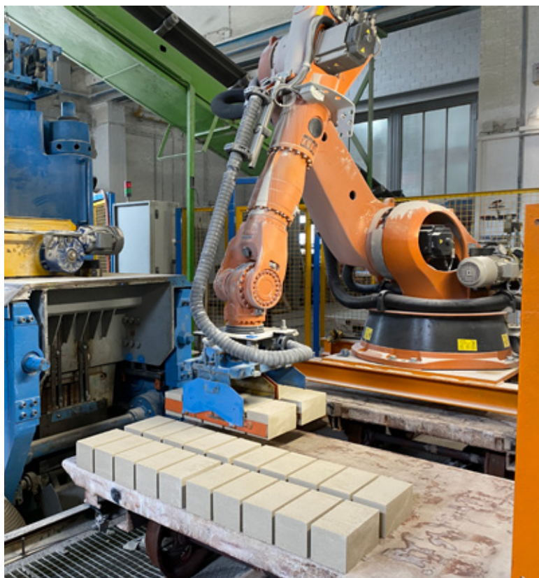
Werkversuche zur Herstellung von Kalksandsteinmustern mit Calciniertem Ton.
