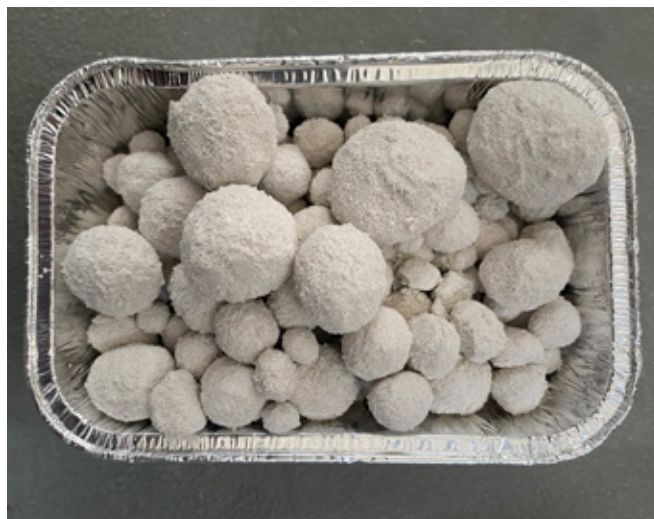
Hydrothermalgranulate aus Kalksandstein-Recycling-Material – Durchmesser der Granalien: 5 bis 20 mm
