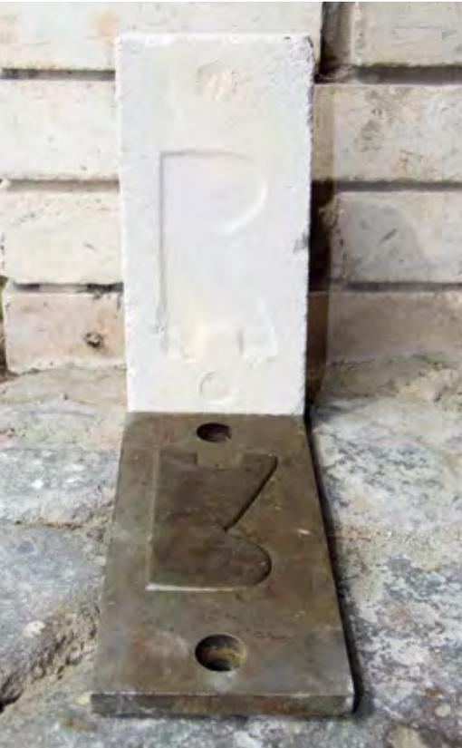
↑ Stempelplatte der ersten Drehtischpresse mit der Prägung »R«, aus den 20er-Jahren für die Kennzeichnung von Steinen aus dem Rodinger Werk. Weitere Einzelteile der ersten Pressen sind auch noch im Ersatzteillager vorhanden.
