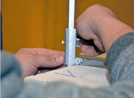
Bild 8 Kalksandsteine sind sehr maßgenau.
