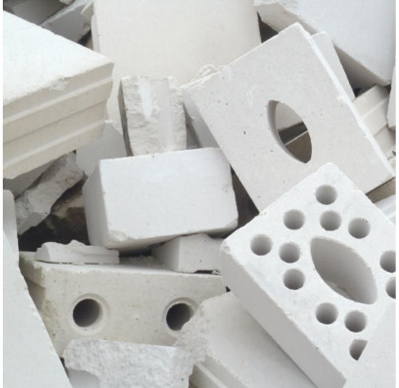
Das Kalksandstein-Recycling-Material vor der Aufbereitung für die weitere Verwendung als Tragschicht (AiF-Nr.: 18119).
