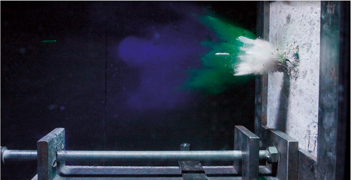
**Bild 19** Ein Projektil durchschlägt das Mauerwerk. Die Aufnahme wurde mit einer Hochgeschwindigkeitskamera gemacht.
