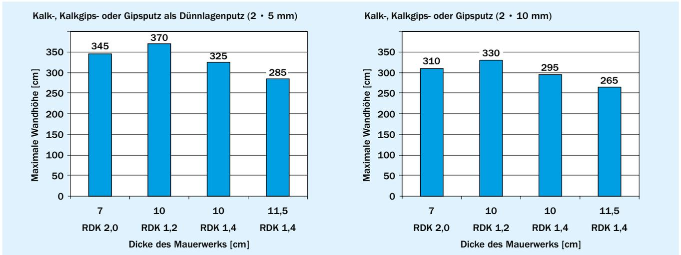
**Bild 5** Grenzhöhen typischer nicht tragender KS-Wandkonstruktionen mit Dünnbettmörtel bei einem zulässigen Gesamtgewicht von max. 5 kN/m
