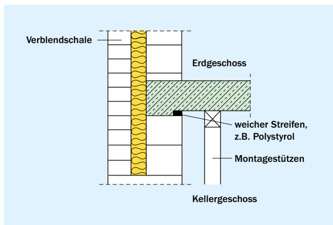
Bild 31 Konstruktive Zentrierung
