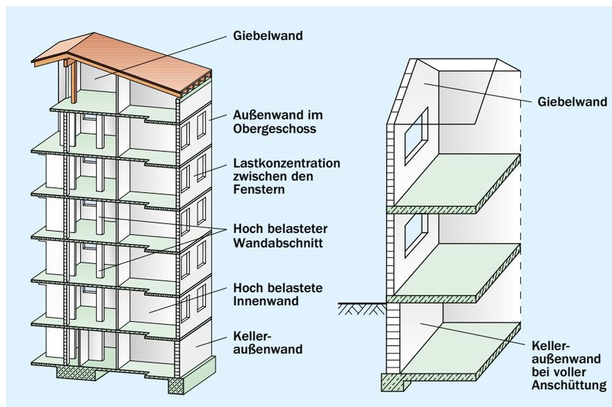
Bild 3 Wichtige Bauteile und wesentliche Nachweisstellen im Mauerwerksbau
