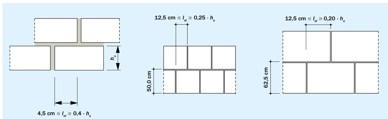
Bild 29 Mindestüberbindemaß  $I_{oi}$  nach DIN EN 1996-1-1/NA
