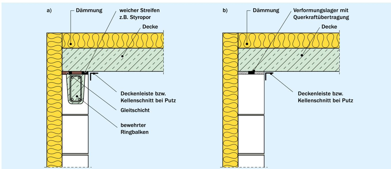
Bild 34 Konstruktive Maßnahmen zur Zentrierung der Deckenauflegerkraft am Beispiel der Außenwand unter einer Dachdecke
