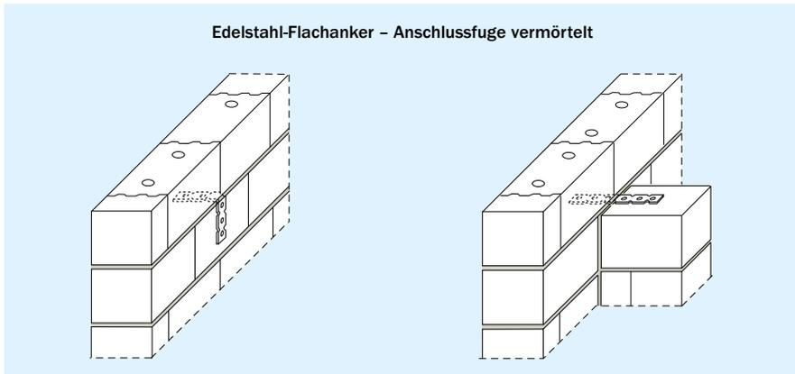
Bild 37 Anwendung von Edelstahl-Flachankern bei der KS-Stumpfstoßtechnik
