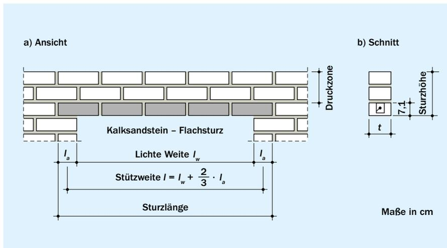
Bild 26 Bezeichnung bei Flachstürzen
