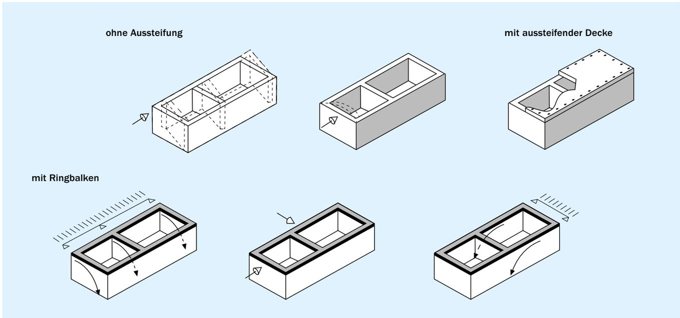
Bild 11 Formstabilität durch Anordnung von Ringbalken (nach [15])
