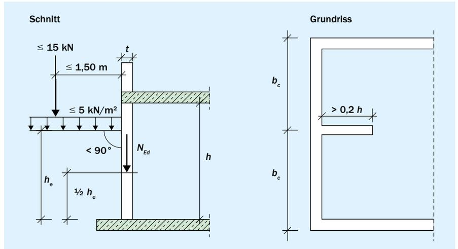
Bild 21 Nachweis von Kellerwänden nach DIN EN 1996-3/NA
