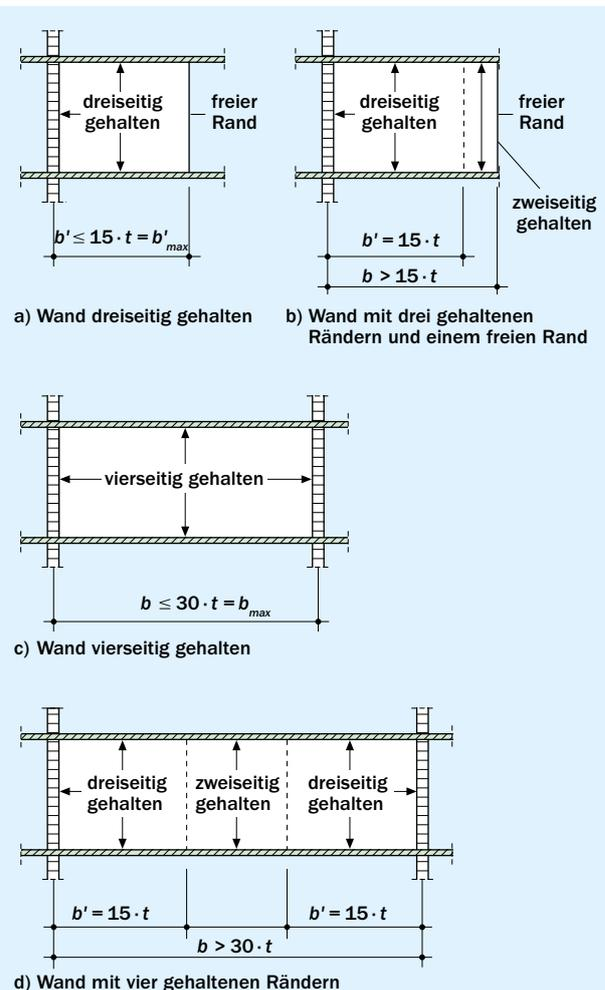
Bild 12 Einfluss der Wandbreite auf die Halterung
