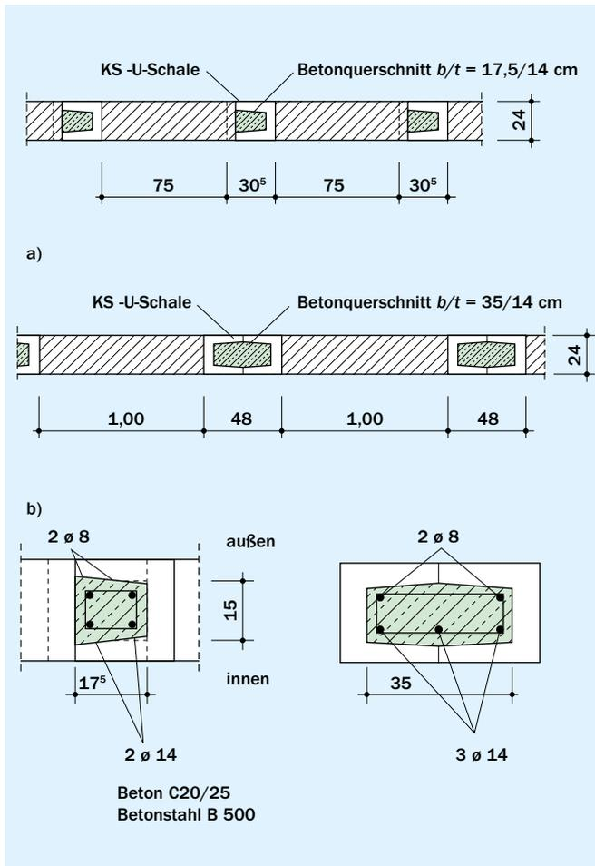
Bild 24 Aussteifende Stahlbetonstützen unter Verwendung von KS-U-Schalen
