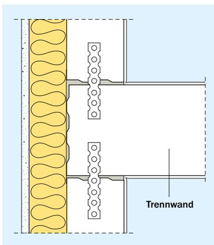
Bild 39 Stumpfstoßtechnik mit durchlaufender Trennwand
