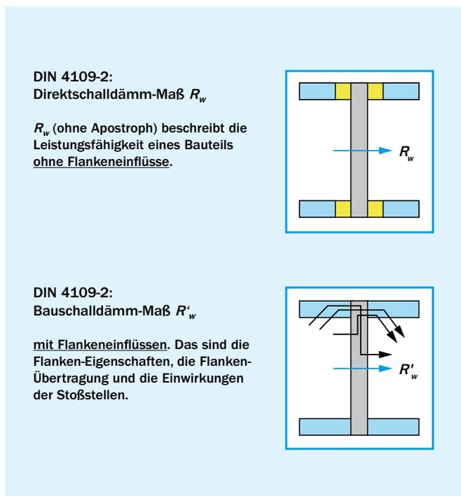
Bild 11 Direktschalldämm-Maß  $R_w$  und bewertetes Bauschalldämm-Maß  $R'_w$
