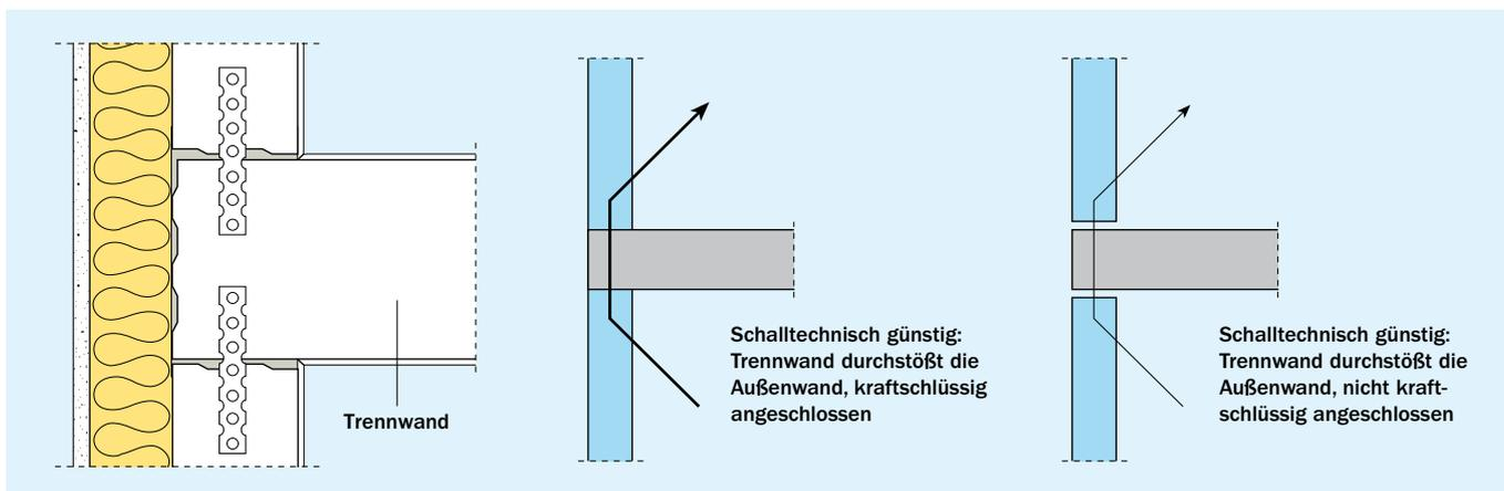
Bild 21 T-Stoß: Trennwände durchgehend, flankierende Wände stumpf angeschlossen
