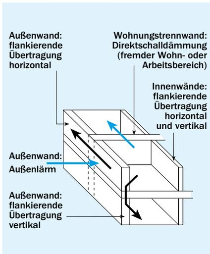
**Bild 23** Einbindung der Außenwand in das schalltechnische Gebäudekonzept
