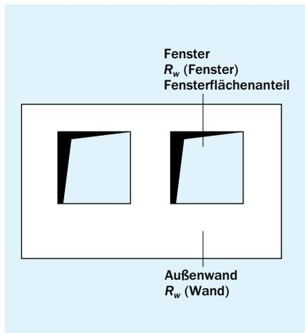
Bild 39 Wand mit Fenstern: Teilflächen unterschiedlicher Schalldämmung
