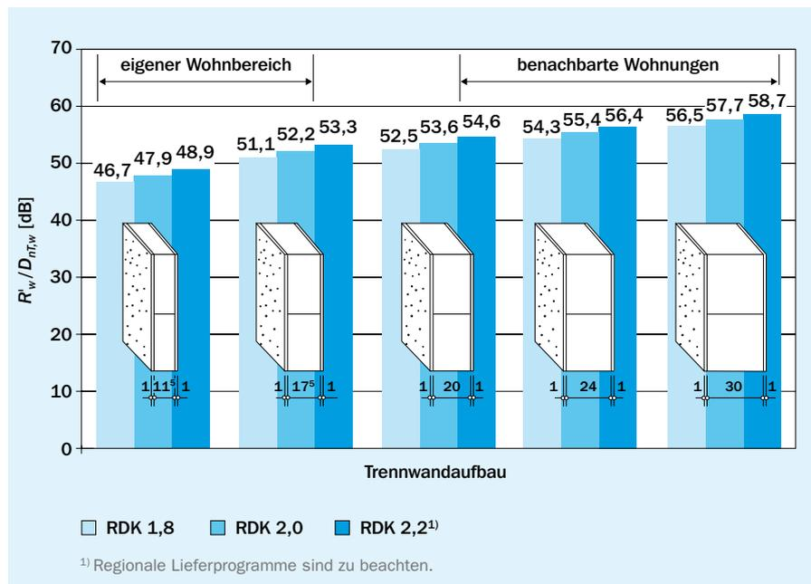
Bild 19 Beispiele für Schalldämm-Maße in Abhängigkeit von Wanddicke und Wandrohichte
