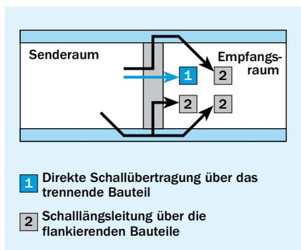
Bild 4 Schallschutz im Gebäude – direkte und flankierende Schallübertragung
