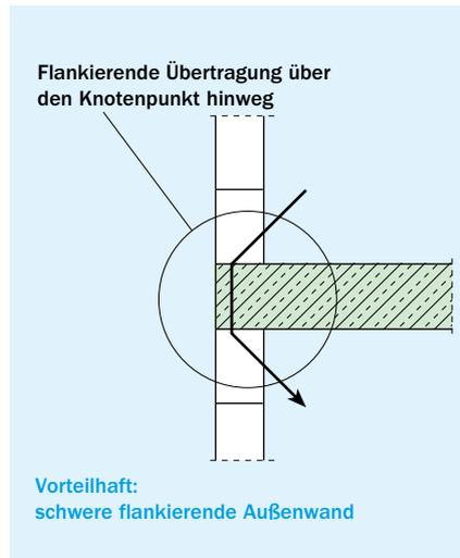
**Bild 24** Flankierende Übertragung (vertikal) über die Außenwand
