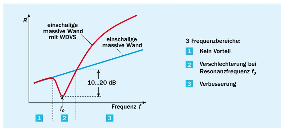
Bild 36 Schalldämmung  $R$  der einschaligen, massiven Wand ohne und mit WDVS
