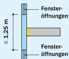
Diese Ausführung ist nicht zu empfehlen. Eine Verschlechterung der Schalldämmung ist möglich.
