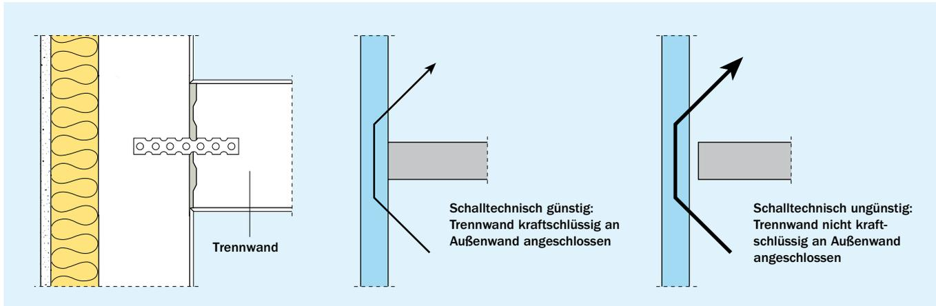
Bild 20 T-Stoß: flankierende Außenwand durchgehend, Trennwand stumpf angeschlossen
