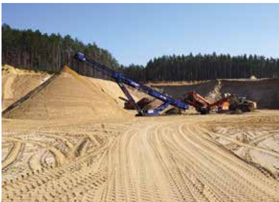
Im KW Steinwalde-Ost der CEMEX Kies Mecklenburg-Strelitz GmbH wird zu Beginn der Aufbereitung der Sand trocken abgesiebt, Foto: BGR.
