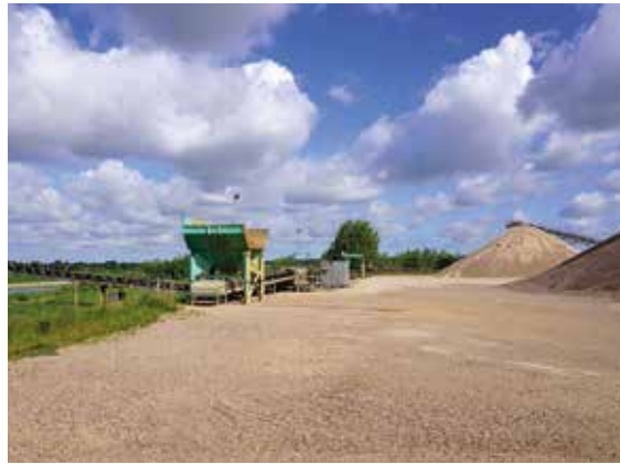
Im KW Estorf erfolgt die Beladung von Binnenschiffen über ein Förderband, das jedoch jeweils mit Radlader beschickt werden muss, Foto: BGR.
