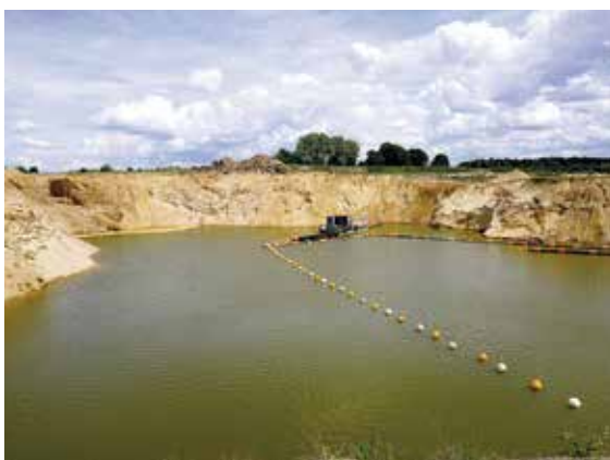
Im Sandwerk Grauen der WRM-REESE-Unternehmensgruppe hat der zur Gewinnung eingesetzte Saugbagger immer wieder mit Einschaltungen von lehmigen Sand und Grundmoräne in den stark gestauchten Sanden zu kämpfen, Foto: BGR.
