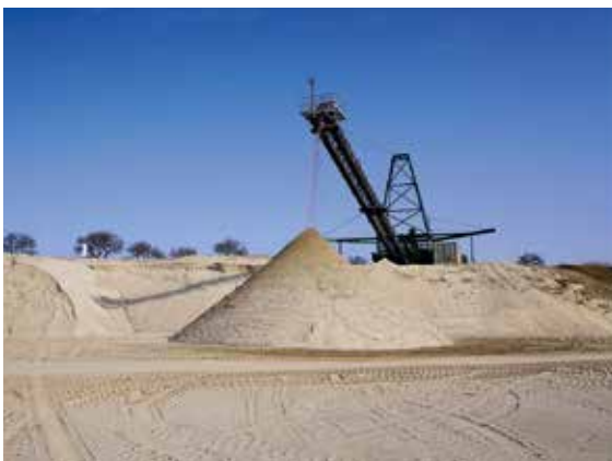
Im KW Lüttow-Valluhn fallen große Mengen an Feinsand/Zyklonsand an, die zur Einstellung der Schlackenparameter bei der Kupferproduktion an die Aurubis AG in Hamburg verkauft werden, Foto: BGR.
