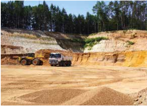
In der Sandgrube Röttenbach-Mühlstetten werden hochwertige quarzreiche Sande abgebaut, die nach Wäsche in bis zu 70 km Entfernung vor allem als Betonsande Verwendung finden, Foto: BGR.
