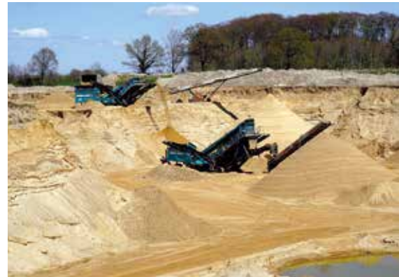
Im KW Borstel der Giese Kiesaufbereitungsges. mbH werden die dort bis zu 15 m mächtigen Kiessande sowohl aus zwei Baggerseen, als auch im Trockenen gefördert, Foto: BGR.
