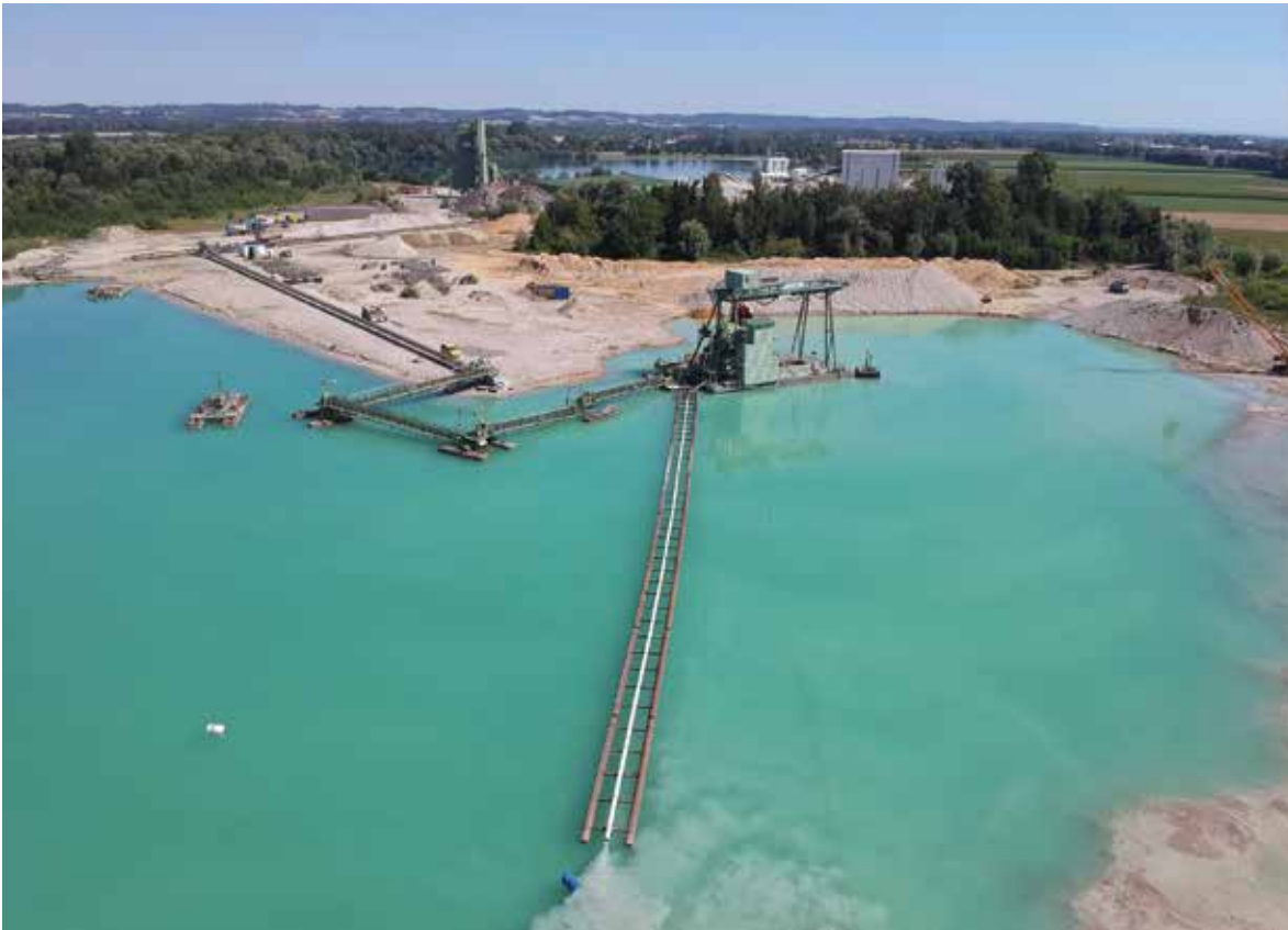
Im KW Moosburg ist ein großer Schwimmgreifer in der Auskiesung tätig, mit dem jedoch nur die obersten Meter des wesentlich mächtigeren Kiessandhorizontes abgebaut werden dürfen, Foto: Rohrdorfer Gruppe (mit frdl. Genehmigung).
