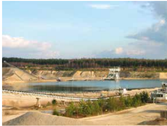
Im KW Moholz nördlich Niesky in der Oberlausitz werden saale-eiszeitliche Schmelzwasserkiessande mittels Schwimmgreifer gewonnen, Foto: Heim Niederschlesische Kieswerke GmbH & Co. KG (mit frdl. Genehmigung).
