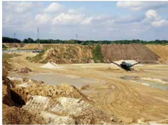
In der Sandgrube Goldbeck der Holcim Kies und Splitt GmbH erfolgt die Gewinnung der Sande sowohl im Trockenen (Vordergrund), als auch im Nassen (Hintergrund), Foto: BGR.
