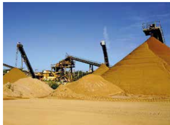
Im KW Forster Feld der Franz-Josef Schüssler Kieswerk GmbH & Co. KG werden ein trocken abgesiebter „Mauersand 0/4 mm“, ein gewaschener Betonsand 0/2 mm und ein aus dem Prozessabwasser abgetrennter Feinsand 0/1 mm produziert, Foto: BGR.
