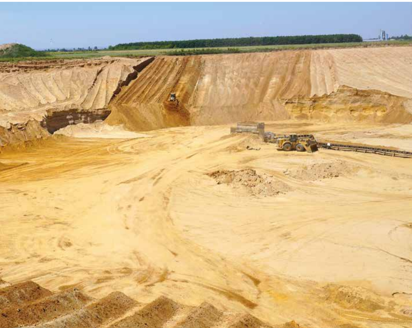
Blick in das derzeitige Abbaufeld des KW Strassfeld-Müggenhausen der Rheinische Baustoffwerke GmbH. Wie in allen Trockenabbaustätten der Rheinische Baustoffwerke GmbH in der Kölner Bucht erfolgt die Abschiebung der Kiessande mittels einer Raupe zur Grubensohle, von wo sie mit einem Radlader auf ein Förderband Richtung Aufbereitungsanlage aufgegeben werden, Foto: BGR.
