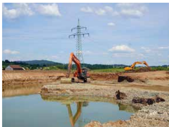
Sowohl für den Abtrag des Abraums wie auch für die Gewinnung der groben und relativ geringmächtigen Kiessande im Obermaintal zwischen Maineck und Mainroth bieten sich Hydraulikbagger an, Foto: BGR.
