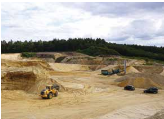
Blick in die Kiessandgrube Wagenfeld der Wiechert GmbH. Diese liegt in der Stauchendmoräne des Kellenbergs, wo bis zu 5 m mächtige Linsen von Beckenschluffen und Geschiebelehm in Schmelzwassersande und -kiessande eingeschuppt wurden, Foto. BGR.
