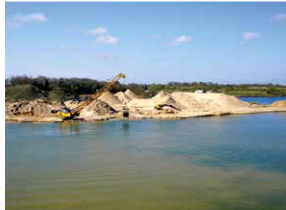
Im KW Ahrenshöft der Firma Reinhard Jans Kieswerk erfolgt die Gewinnung der körnungsarmen Kiessande unterhalb des Grundwasserspiegels durch einen Seilbagger, Foto: BGR.
