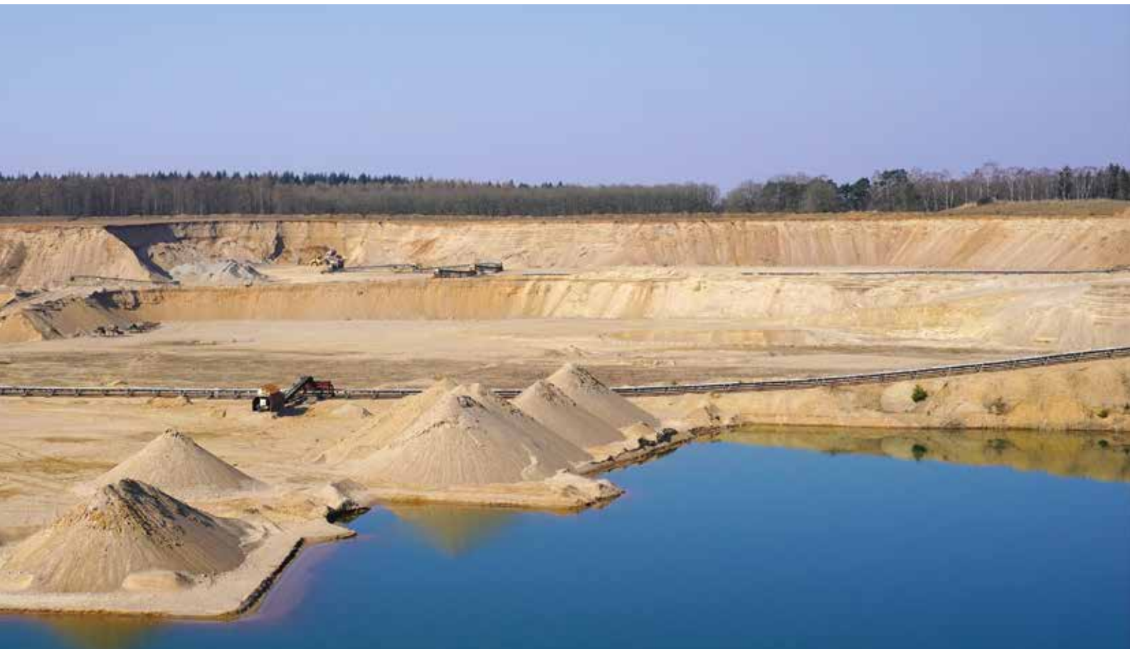
Der große Kiessandtagebau Klocks in besitzt eine Sandaufbereitungsanlage und eine effiziente Bahnverladung, so dass Betonwerke oder Großbaustellen in Süddeutschland leicht mit fast unbegrenzten Mengen an feiner Gesteinskörnung (Sand) versorgt werden könnten, Foto: BGR.
