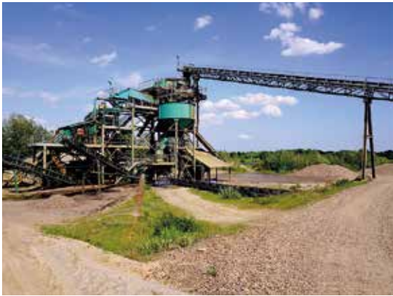
Wie in fast allen Kieswerken entlang der Mittelweser ist auch im KW Stolzenau eine Entkohlung der Kiessande im Zuge ihrer Aufbereitung unverzichtbar, Foto: BGR.
