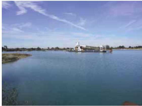
Der zur Auskiesung vorgesehene schwimmende Eimerkettenbagger im „Kronthaler Weiher“ bei Erding liegt trotz großer verbliebener Kiessandvorräte seit vielen Jahren still, Foto: BGR.
