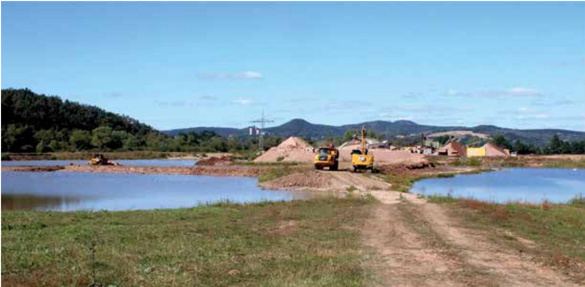
In der Fuldaaue bei Bebra wird bis zu 6 m mächtiger Kiessand gewonnen und aufbereitet, Foto: Helmut Beisheim GmbH & Co. KG (mit frdl. Genehmigung).
