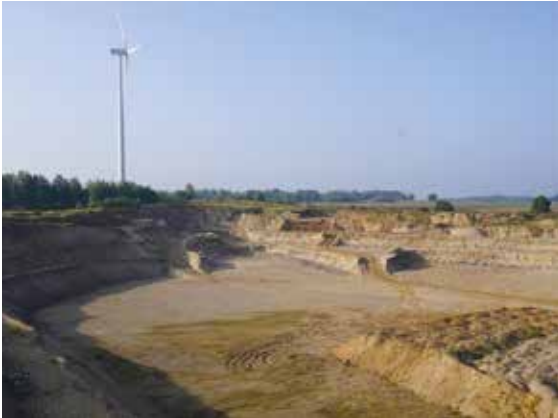
Morgendlicher Blick in die CEMEX-Kiessandgrube Kraatz, die aufgrund ihrer Hügellage von großen Windkraftanlagen umgeben ist. Im rechten Vordergrund sichtbar die sukzessive Verfüllung mit nicht verkaufsfähigem Material (bindiger Abraum, Geschiebemergel, Feinsand), Foto: BGR.
