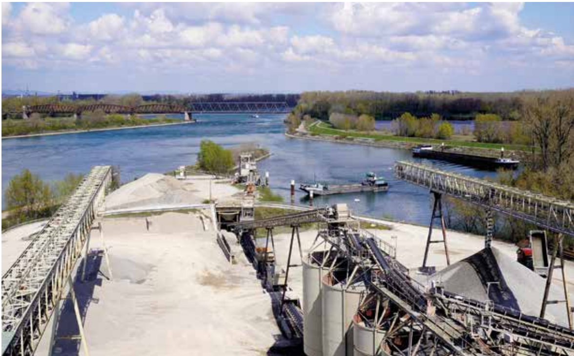
Eine Schute des Wasserstraßen- und Schifffahrtsamtes Freiburg dockt täglich viele Male, je nach Hochwasserlage, an der Schiffsverladung des KW Iffezheim an, um nach Beladung mit jeweils 265 t Kiessand 0/63 mm dieses Material unweit nördlich im Rhein als „Geschiebezugabe“ zur Flussbettregulierung wieder zu versenken, Foto: BGR.
