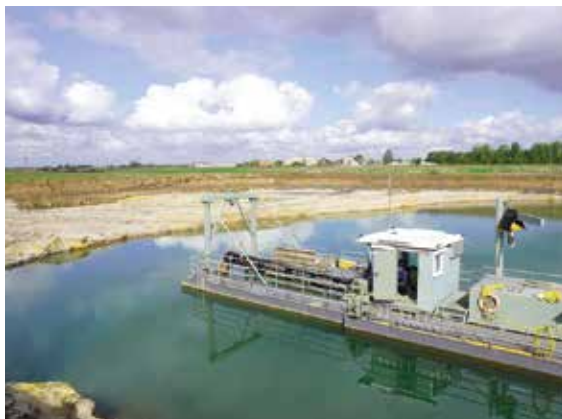
Im Abbaufeld Tornitz 2 des KW Tornitz (im Hintergrund) erfolgt die Gewinnung der Kiessande der Saale mittels Saugbagger, Foto: BGR.
