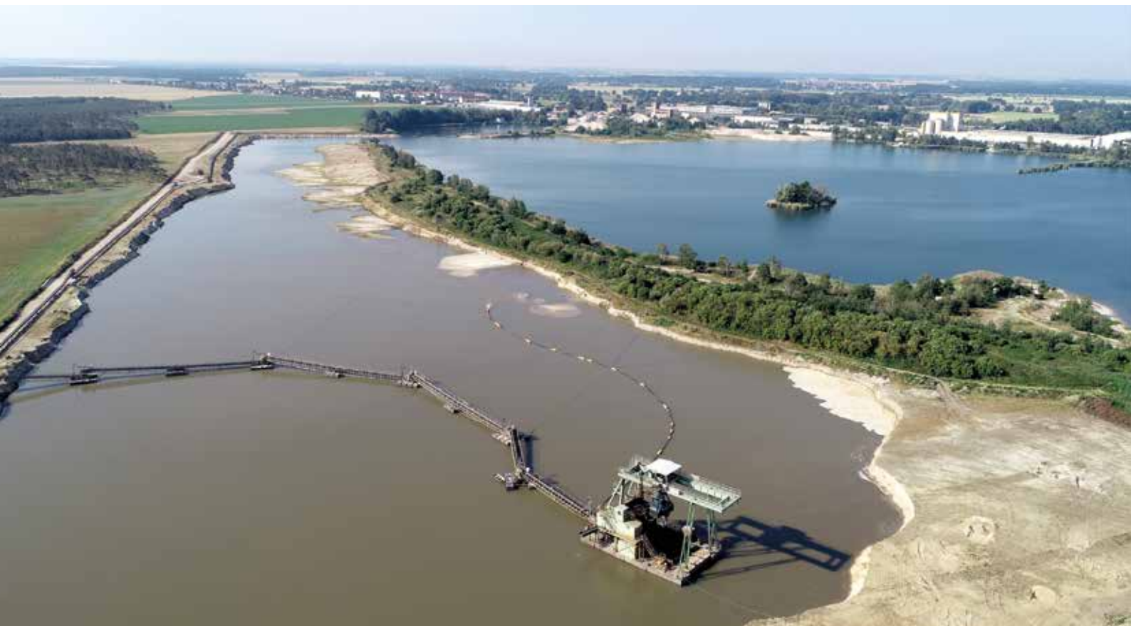
Luftaufnahme des KW Laußig mit Schwimmgreifer im Neusee im Vordergrund, ausgekiestem Altsee in der Bildmitte rechts sowie an dessen rechtem Ufer die am Standort produzierenden Porenbeton- und Beton-schwellenwerke, Foto: Mitteldeutsche Baustoffe GmbH (mit frdl. Genehmigung).
