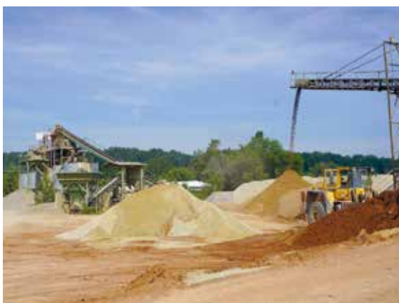
Im KW Baunach der Andreas Schorr GmbH & Co. KG werden sowohl Mainsande und -kiese (rötlich) als auch Dolomit- und Kalksteinsplitte (hellbraun) aus einem unternehmenseigenen Steinbruch gewaschen und aufbereitet, Foto: BGR.
