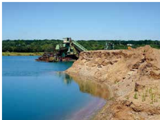
Nördlich Wietersheim erfolgt die Gewinnung der Weserkiessande durch die Kiesbaggerei Lahde / Weser GmbH mit einem schwimmenden Eimerkettenbagger, wodurch sich die Uferschwalben, die in dem darüber lagerndem Auelehm ihre Bruthöhlen bauen, nicht stören lassen, Foto: BGR.
