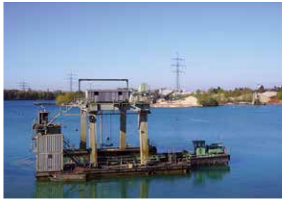
Blick auf den Baggersee der Fa. EKS Eugen Kühl und Söhne GmbH & Co. KG von Nordosten mit Schwimmgreifer im Vordergrund, Elevierbagger im Hintergrund rechts und Kieswerk im Hintergrund Mitte, Foto: BGR.
