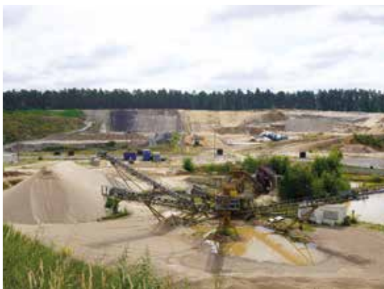
Im Kiessandtagebau Alt-Golm der HTS Landschaftsgestaltungs GmbH werden Kiessande trocken und nass aufbereitet und eine Deponie der Klasse 1 (Hintergrund) betrieben, Foto: BGR.
