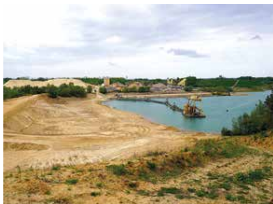
Im KW Negenborn der GP Günter Papenburg AG werden die Kiessande des Stauchendmoränenzugs der Brelinger Berge sowohl im Trockenen, als auch in einem zweiten Abbauschnitt im Nassen mittels Schwimmgreifer abgebaut, Foto: BGR.
