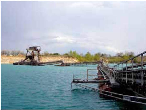
Im KW Durmersheim der Kies und Beton AG erfolgt die Gewinnung der rund 35 m mächtigen Kiessande mittels Schwimmgreifer. Die über dem Grundwasserspiegel lagernden Kiessande brechen beständig in den Baggersee nach, Foto: BGR.
