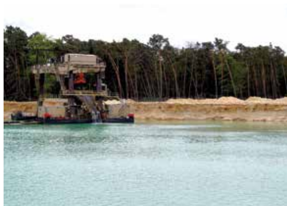
In ihrem neuen Baggersee darf die Heinz Mitteldorf Sand und Kies GmbH & Co. KG Kiessande bis in 25 m Tiefe gewinnen. Aufgrund zahlreicher Tonlinsen ist hierfür ein eigentlich völlig überdimensionierter Schwimmgreifer notwendig, Foto: BGR.
