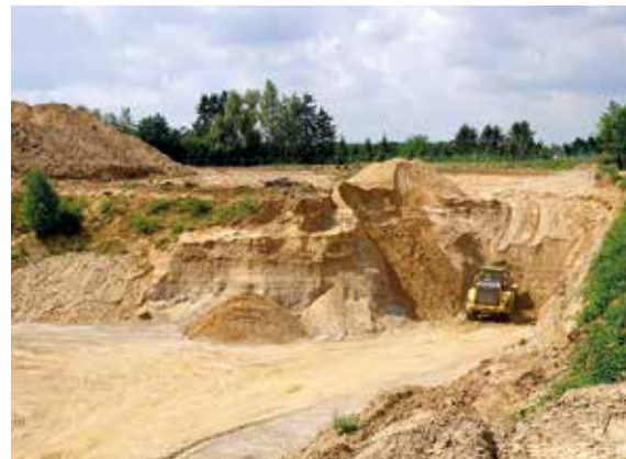
Das KW Troisdorf-Eschmar wird seit Ende 2021 nur noch aus regionalen Trockenabbaustellen, wie dieser kleinen firmeneigenen Kiessandgrube nördlich Mondorf mit Rohkiessand versorgt, Foto: BGR.
