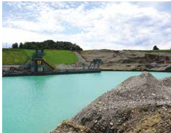
Im KW Pfullendorf werden die unterhalb des Grundwasserspiegels anstehenden Schmelzwasserkies-sande mit einem schwimmenden Eimerkettenbagger, die im Trockenem anstehenden Kiessande jedoch zuvor mit einem Hydraulikbagger gewonnen, Foto: BGR.
