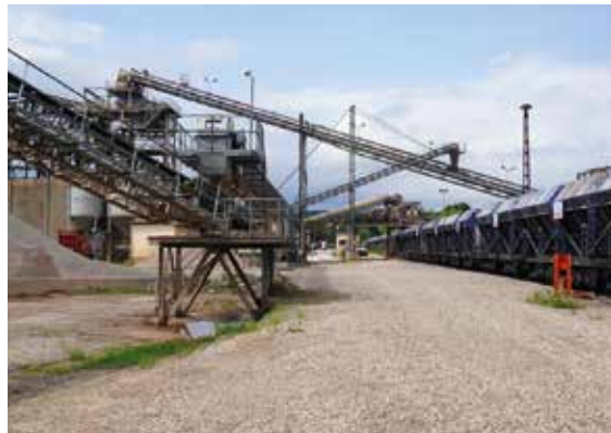
Täglich verlässt ein Vollzug mit 2.800 t Nutzlast das KW Immelborn der CEMEX Kies & Splitt GmbH. Am Ende seiner Reise in Berlin oder Hamburg wird der Zug durch ein selbstentladendes Förderband unterhalb der Waggons wieder entladen, Foto: BGR.
