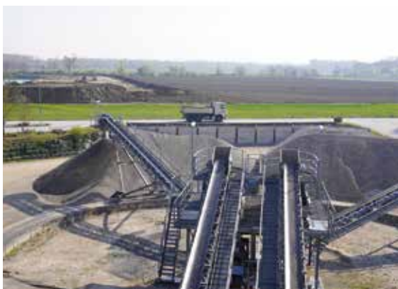
Im KW Waldsee der Rohr-Unternehmensgruppe werden hochwertige Sande und Kiese erzeugt, während auf der Erweiterungsfläche (Hintergrund) die Abraumarbeiten für den sich nähernden Saugbagger laufen, Foto: BGR.
