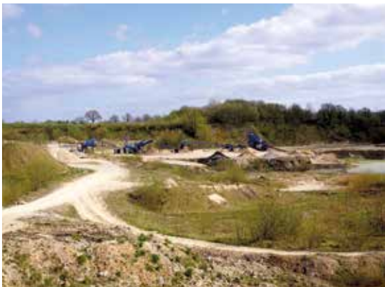
Im weitläufigen Abbaugelände bei Juhlschau werden die Kiessande der Flensburger Stauchendmoräne sowohl im Trockenen als auch im Nassen abgebaut, Foto: BGR.
