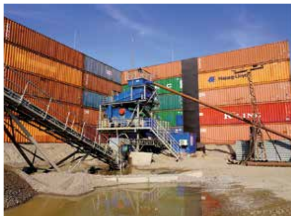
Gegen die Wiederaufnahme der Gewinnung und Aufbereitung im Bergwerkseigentum Pinnow-Nord bildete sich eine Bürgerinitiative, der es vor allem um den Lärmschutz geht. Um diesen geforderten maximalen Lärmschutz schnellstmöglich zu erreichen, umgab das Unternehmen Dörner die dortige kleine Aufbereitungsanlage mit einer hohen Wand aus Überseecontainern, Foto: BGR.
